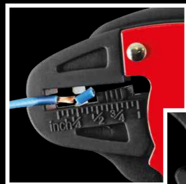
Skidanje izolacije Wire stripping
