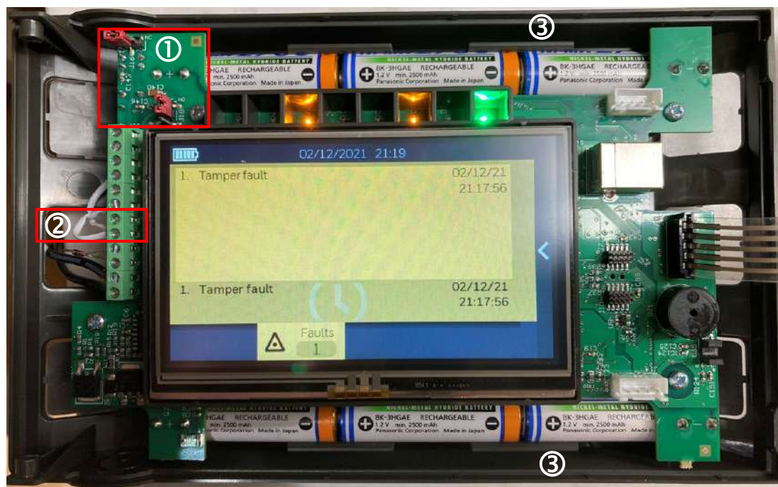
Фиг. 17: Общ преглед на настройването и връзките на LT-159
